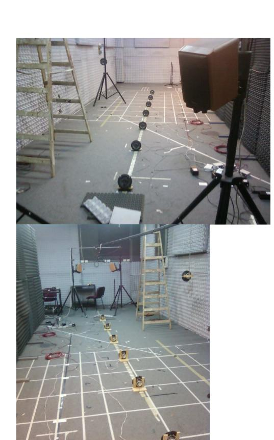
La primera vez que se realizó este método en este experimento para obtener las respuestas impulso se pudo ver un resultado no deseado, ya que en las respuestas impulso aparecía ensuciando la imagen de la misma, una reflexión de una de las paredes del laboratorio, la cual no debía aparecer para el correcto análisis de las respuestas impulso.
